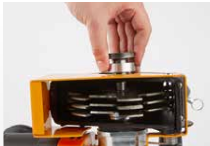
Changement d'outil sans effort grâce à un arbre de sécurité divisé et à des rondelles d'écartement précises
